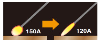
アーク長が長くなり電圧が上昇することで、電流が減少
